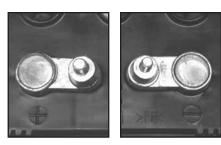
POSITIVE POST HAS LARGER DIAMETER NEGATIVE POST HAS SMALLER DIAMETER
